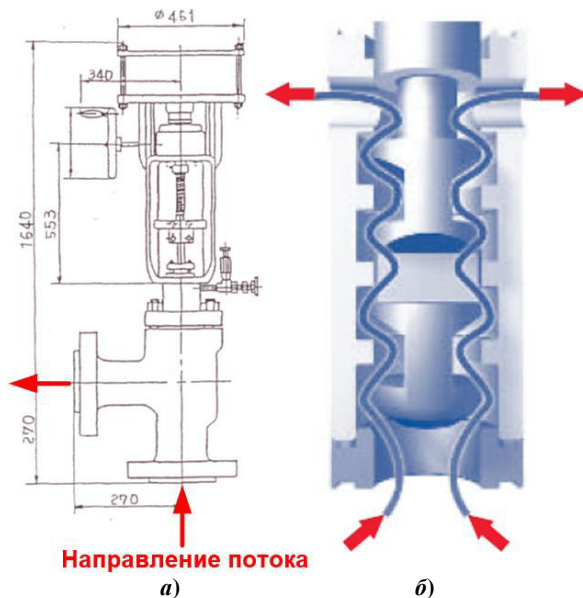
Рис. 2. Дроссельный узел углового многоступенчатого клапана Masonelan с осевым потоком: а) Габаритный чертеж; б) схема
